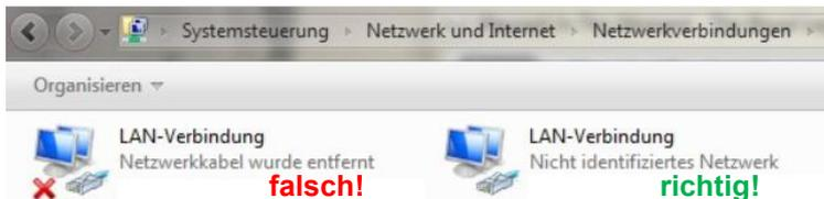
Wenn Sie die Kabelverbindung überprüft haben und dennoch die Meldung „Netzwerkkabel entfernt“ (links dargestellt) erscheint, dann ist vermutlich das Netzwerkkabel (**LILA**), welches aus dem Tresor herauslegt wurde, defekt. Verwenden Sie bitte zur Prüfung ein neues (normales / kein Crossover) Netzwerkkabel und verbinden Sie dies direkt mit der TwinIP und Ihrem Laptop/PC.
