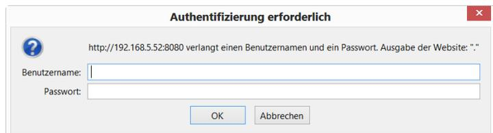
Wenn Sie eine der genannten Seiten sehen oder eine Passwortabfrage erhalten, ist die Verkabelung und Installation **erfolgreich** abgeschlossen. Ihr System benötigt lediglich eine Software-Aktualisierung. Folgen Sie dem Schritt 14 (TwinNet Oberfläche oder Passwort Abfrage), um die Software zu aktualisieren.
