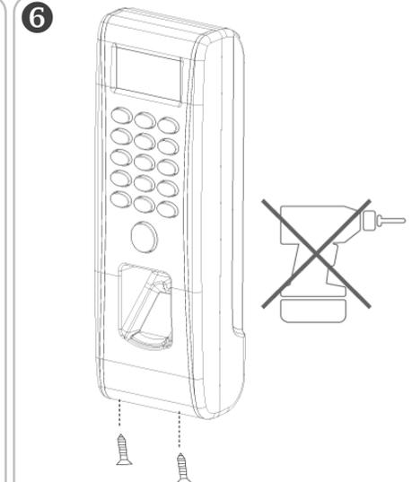
Führen Sie alle Stecker und Kabel durch die Kabeldurchführung und befestigen Sie vorsichtig die Schrauben auf der Unterseite des Gerätes.
