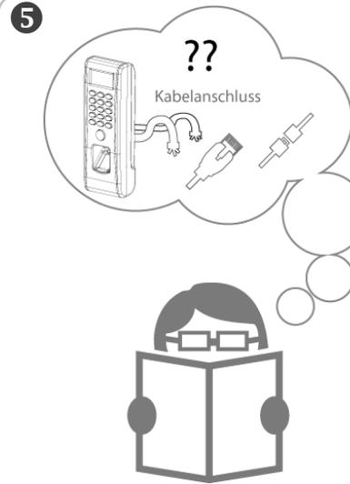
Bevor Sie das Terminal an der Wand befestigen, testen Sie die Funktion und Verkabelung gemäß des Kabel- und Anschlussplans (*siehe Rückseite*).
