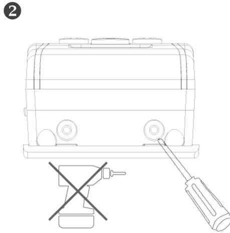
Lösen Sie vorsichtig die Schrauben auf der Unterseite des Gerätes. Verwenden Sie keinesfalls einen Bohrer oder Akkuschrauber!
