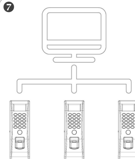
Melden Sie sich mit der ID-Nummer **0** und dem PIN **123456** im ► Menü an und hinterlegen Sie unter ► Einstellungen ► Netzwerk die IP-Daten.
