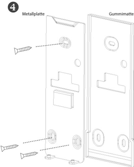
Befestigen Sie Gummimatte und Metallplatte an der Wand. Die Gummiplatte dient als Isolations-schicht zwischen Metallplatte und Wand.
