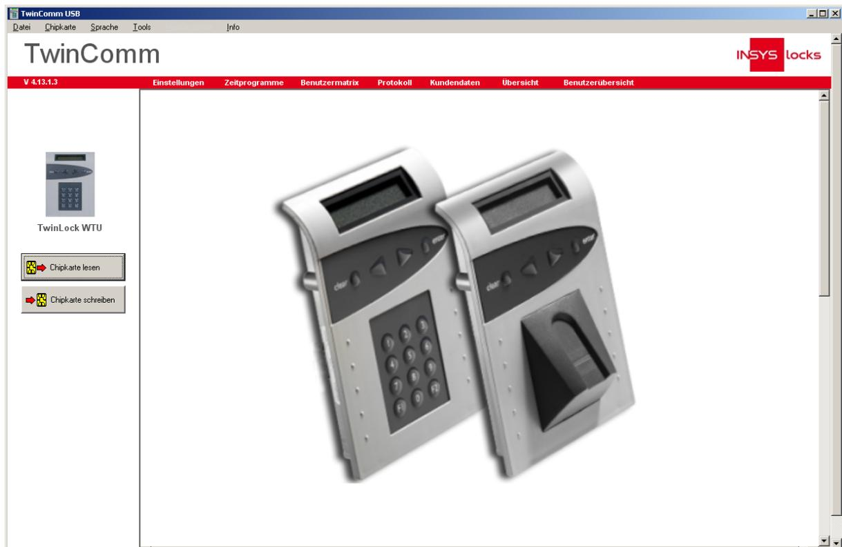
Zum Einlesen der Daten von der Chipkarte „**TwinCard configuration II**“ muss diese in den Chipkartenleser eingelegt werden, und der Button „**Chipkarte lesen**“ in der TwinComm Software betätigt werden.
