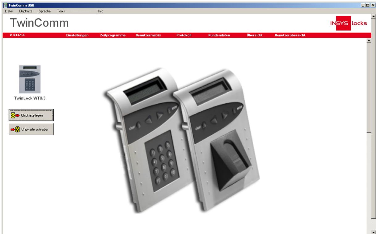
Zum Einlesen der Daten von der Chipkarte „**TwinCard configuration II**“ muss diese in den Chipkartenleser eingelegt werden und die Schaltfläche „**Chipkarte lesen**“ in der TwinComm Software muss betätigt werden.
