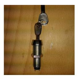
Die Kabel des Schlüsselschalters (normal rot/schwarz) werden an die **Schraubklemme E16** der Platine geklemmt (welche Ader unter welche Schraube ist egal) Er dient dazu, dass der Rechner ordnungsgemäß herunter gefahren wird.
