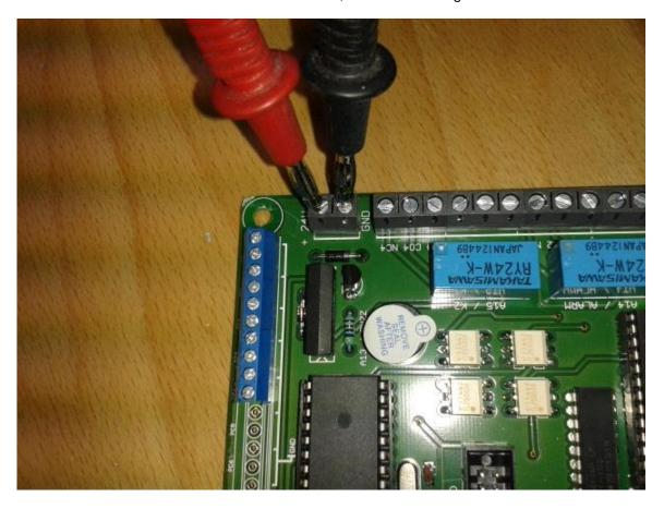
Man kann Messen, ob das Relais an der Platine, was für den Rechner zuständig ist, defekt ist. Dazu misst man zwischen CO3 und dem – vom Netzteil. Es sollten 12V DC anliegen.
