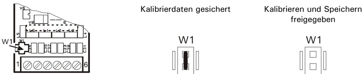
Die Position der Steckbrücke W1 kann vom Eichbeamten mit Faden und Plombe oder Siegel gesichert werden:
